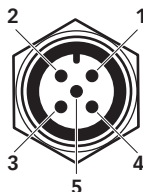
VISTA FRONTALE CONNETTORE M12A MASCHIO
